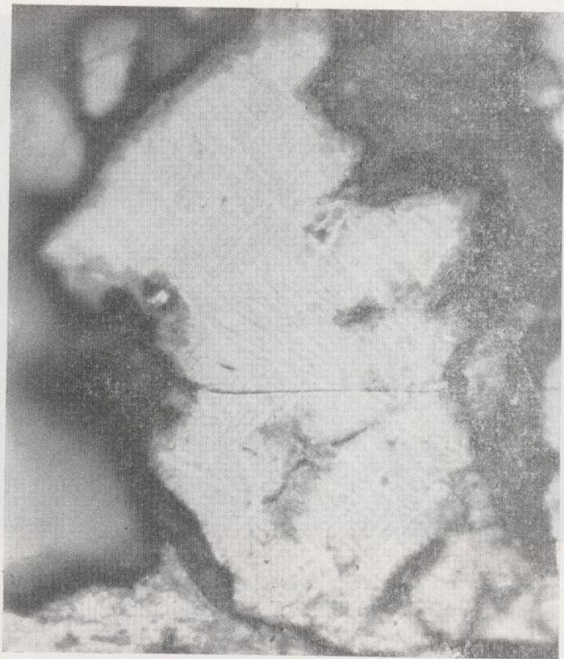
Fig. 1.—Sección pulida. Nícoles paralelos \times 540 . Placa de idaíta (gris claro) surcada por venillas de calcopirita (blanco); ambos reemplazados por covelina (gris oscuro)
