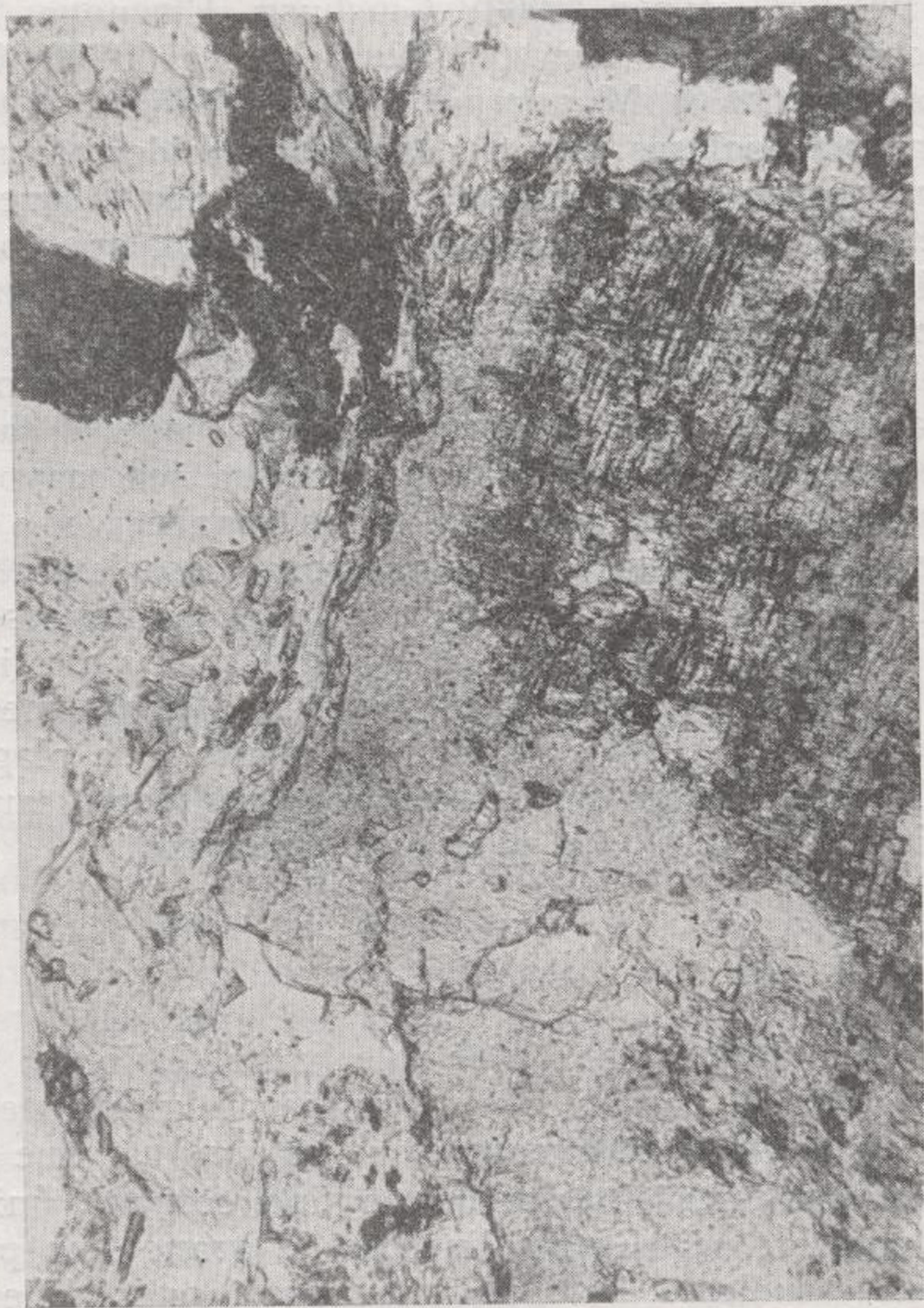
Fot. 3. —Detalle del fenómeno anterior observado en otro cristal de clinopiroxeno (malacolita). Luz natural, 100 D.
